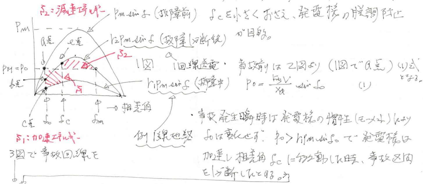
故障直後は  $h_2 P_m \sin \phi > P_0$  の発電機が過速され、1回線で  $\delta_2 = \delta_1$  (加速工率) と減速工率 ( $-h_1 P_m \sin \phi$ ) となる瞬間に安定限界で  $\delta_1 > \delta_2$  では脱調する。
